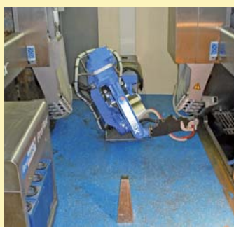
Système à 2 stalles parallèles Bras en fonction
